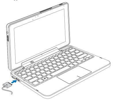
2 Collegare l'alimentatore a una presa elettrica e caricare il tablet e la stazione finché la batteria non è completamente carica.
